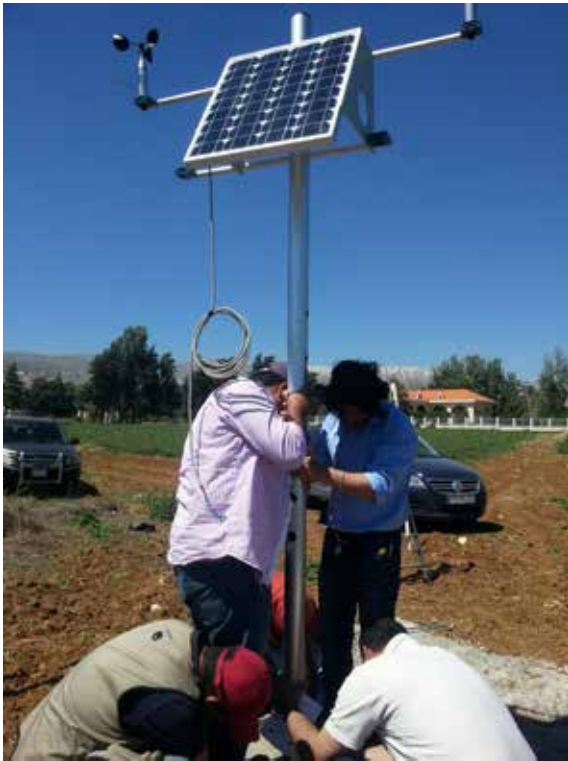
تركيب محطة Bowen ratio لقياس حاجة المحاصيل الفعلية للمياه ETP
