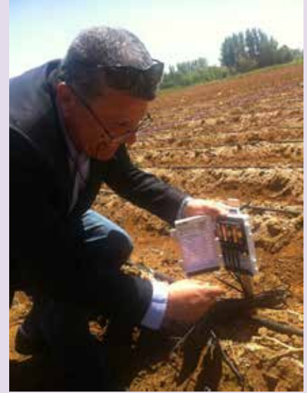
تركيب أجهزة قياس رطوبة التربة (Soil moisture sensor) لمراقبة عمليات الري في حقل التاراب في البقاع (ربيع 2015).
